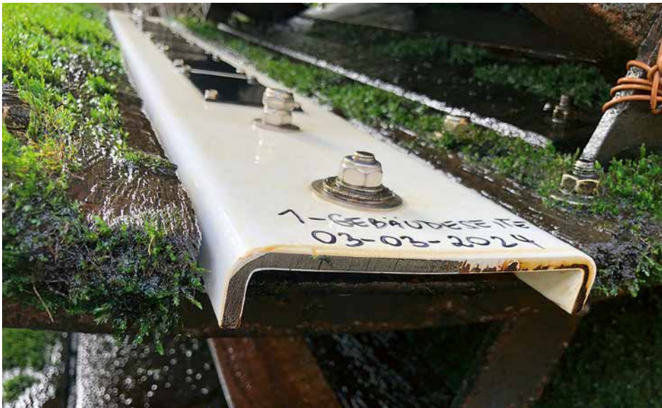
Abb. 9: Künstliche Beschädigung zum Nachweis der funktionierenden Verhinderung von Unterwanderung bzw. Unterrostung der Pulverbeschichtung Quelle: Rainer Rogovits
